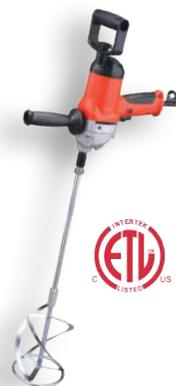
El mezclador manual BNR6169 posee un gatillo de velocidad variable con botón de bloqueo en encendido para funcionamiento continuo. Viene con una conexión para paletas M14 estándar o portabroca de 1/2" (13 mm) para todo tipo de paletas. El asa en D trasera gira 360° y la herramienta tiene un asa lateral desmontable de 3 posiciones. Incluye paleta BNR003-120 y maletín.
