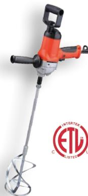
El **mezclador manual BNR6169** posee un gatillo de velocidad variable con botón de bloqueo en encendido para funcionamiento continuo. Viene con una conexión para paletas M14 estándares o portabroca de 1/2" (13 mm) para todo tipo de paletas mezcladoras. El mango en D trasero gira 360° y la herramienta tiene un mango lateral desmontable de 3 posiciones. Incluye paleta BNR003-120 y estuche.
