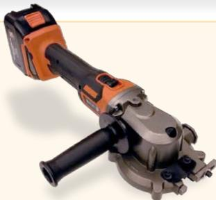
**BNCE-20-24V Cutting Edge Saw™** Esta es una herramienta de corte multipropósito que funciona a baterías de 24 V. Como el modelo eléctrico, puede cortar fácilmente **varillas corrugadas N.º 6 (3/4") [19 mm]**, varillas roscadas, cadenas, conductos EMT, tubos de cobre, varillas de acero, tuberías de acero y mucho más. Además, posee mango de tres posiciones. La capacidad de la apertura es de 0,875" (23,62 mm). Esta herramienta viene completa con dos (2) baterías de ion de litio y cargador.
