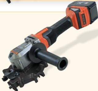
**BNCE-30-24V Cutting Edge Saw™** Esta es una herramienta de corte multipropósito que funciona a baterías de 24 V. Como el modelo eléctrico, puede cortar fácilmente **varillas corrugadas N.º 8 (1") [25 mm]**, varillas roscadas, cadenas, conductos EMT, tubos de cobre, varillas de acero, tuberías de acero y mucho más. Además, posee mango de tres posiciones. La capacidad de la apertura es de 1,18" (30 mm). Esta herramienta viene completa con dos (2) baterías de ion de litio y cargador.
